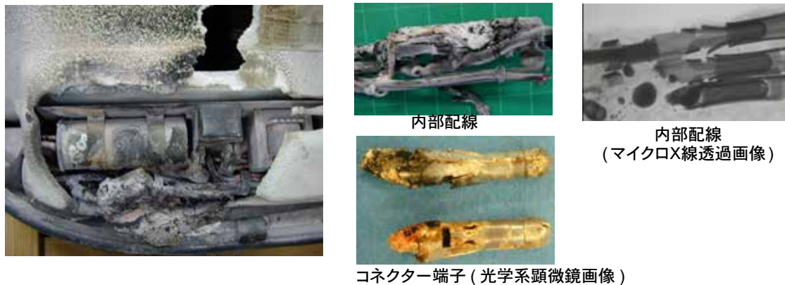
図5 発煙して燃えた車用エアコンの事故事例
