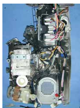
焼損した食器洗い乾燥機
