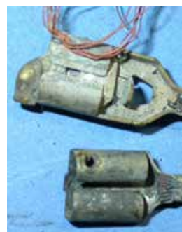
図4 本体および周辺を焦がした除湿器の事故事例
