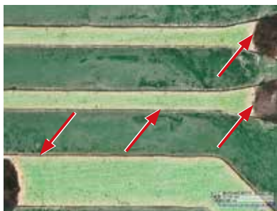
写真7 銅箔が露出しているように見える基板の例 (矢印部位が銅箔が露出しているように見える部分)
