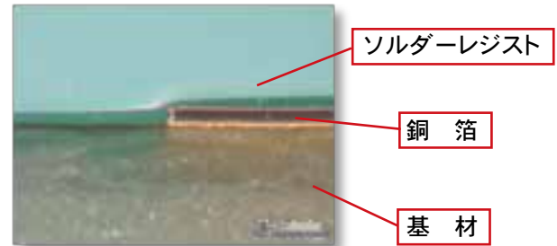
写真6 ソルダーレジストが施された基板の断面 (例)
