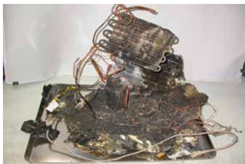
図4 本体および周辺を焦がした除湿器の事故事例
