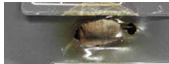
温度コントローラー外郭樹脂の熱溶融、発煙 図 10 電気カーペット温度コントローラー部の熱溶融、発煙事故
