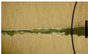
コネクタ端子断面の拡大 (光学系顕微鏡画像)
